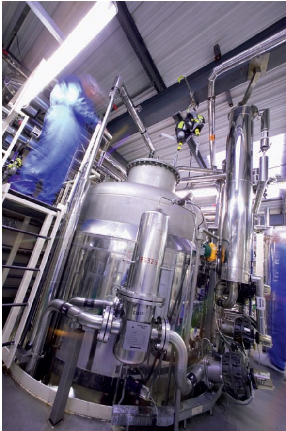
Fermenteur microorganismes Novozymes (photo Kalundborg Danmark)
