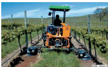
Un outil parmi d'autres de dés herbage mécanique sous le rang
